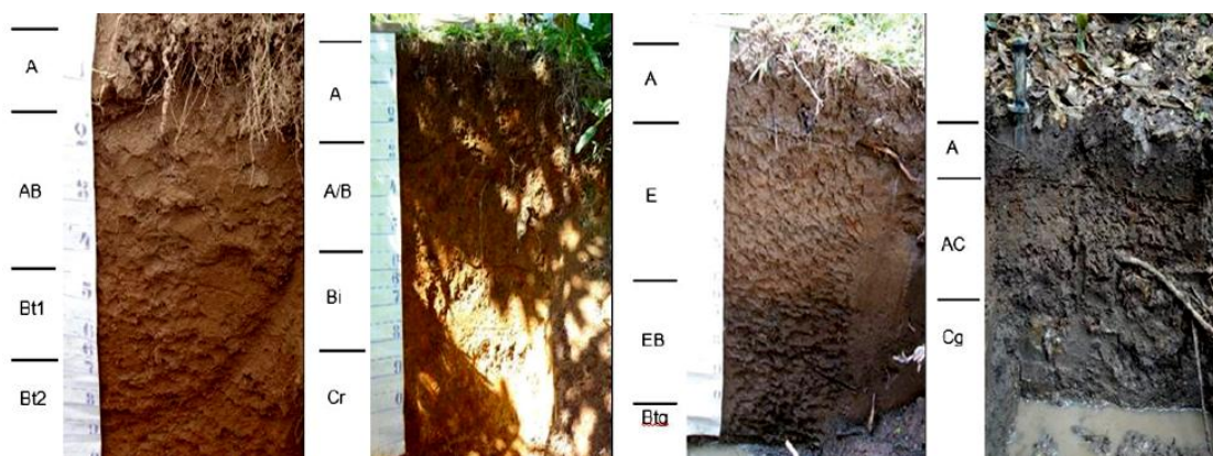
Da esq. para dir.: Argissolo- cor vermelha que indica boa drenagem, aumento de argila em profundidade, intemperismo alto e baixa fertilidade química; Cambissolo- contato com fragmento de rocha a menos de 1 m; Planossolo- imperfeitamente drenado, arenoso e forte acidez até 1 m; Gleissolo- cor cinza resultante da saturação por água a maior parte do ano.
